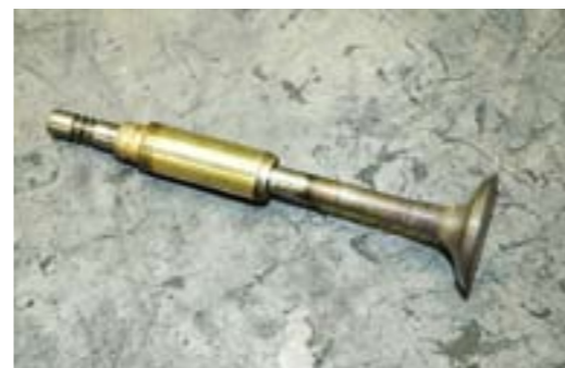
Velké vůle ventilů ve dřívku vinou pilin pronikajících z katalyzátoru
