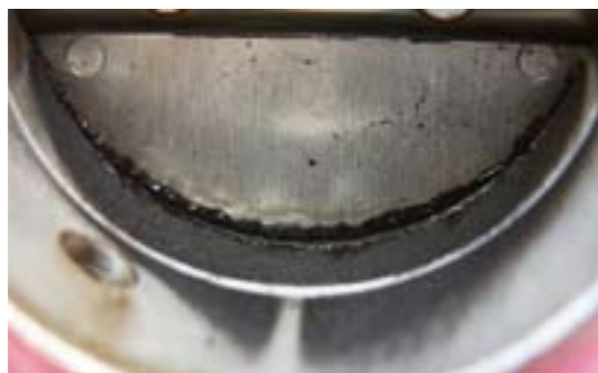
Škrtková klapka zanesená karbonem vinou nevhodného vyústění EGR ventilu v sání
