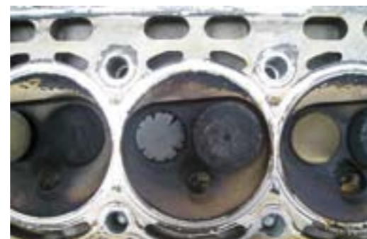
Podpálené výfukové ventily vinou zakarbonovaných hydraulických zdvihátek či příliš velké vůle dřívku
