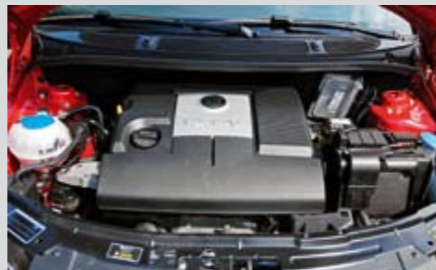
Původní provedení 12V HTP z roku 2003 a výkonem 47 kW mělo vzduchový filtr součástí mohutného krytu
