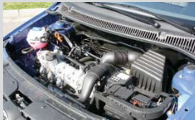
Volkswagen Fox jako první v roce 2005 přinesl provedení filtrboxem na straně, jež není ovlivňována tepelným vyvažováním motoru
