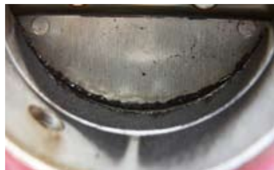
Škrtková klapka zanesená karbonem vinou nevhodného vyústění EGR ventilu v sání
